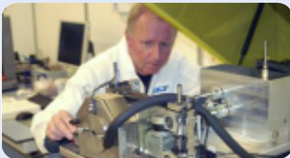
Durch dieses Wissen konnte SKF oft die Branchenstandards für Wälzlagerschmierstoffprüfungen definieren. Emcor, ROF, ROF+, V2F, R2F und Bequiet und andere Prüfungen wurden von SKF für die Leistungsbewertung von Schmierstoffen unter Lagerbetriebsbedingungen entwickelt. Viele dieser Prüfungen werden heute von Schmierstoffherstellern weltweit anerkannt und selbst genutzt.
