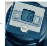
Unità di controllo elettronica con compensazione della temperatura indica il tempo di erogazione e lo stato di funzionamento
