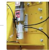
La pressione a 25 bar consente il montaggio fino a 5 m di distanza per ciascuna uscita
