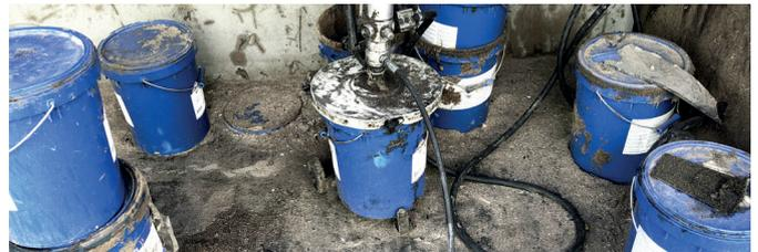
Unsachgemäße Wiederbefüllung der Schmiersysteme führt zu kontaminiertem Schmierstoff im System.
