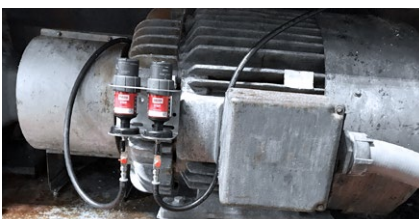
Lubricación de un motor eléctrico mediante montaje a distancia
