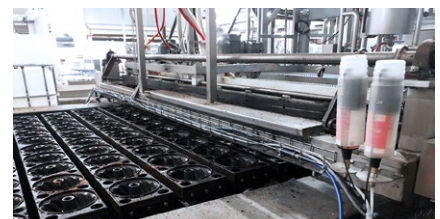
Lubricación en una línea de horneado
