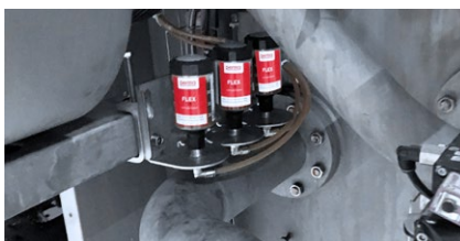
Lubricación de un rodamiento mediante montaje a distancia
