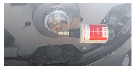
Lubricación del rodamiento de accionamiento de un horno
