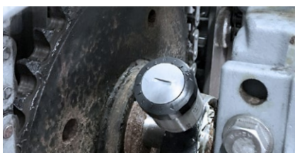
Lubricación de un rodamiento en un tambor de accionamiento
