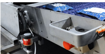
Lubricación de un rodamiento de bridas en una cinta transportadora, montaje a distancia
