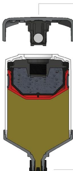
Tapa activadora con unidad generadora de gas integrada (PA GF)
