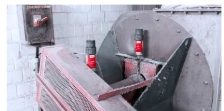
Lubricación de un cojinete de soplador
